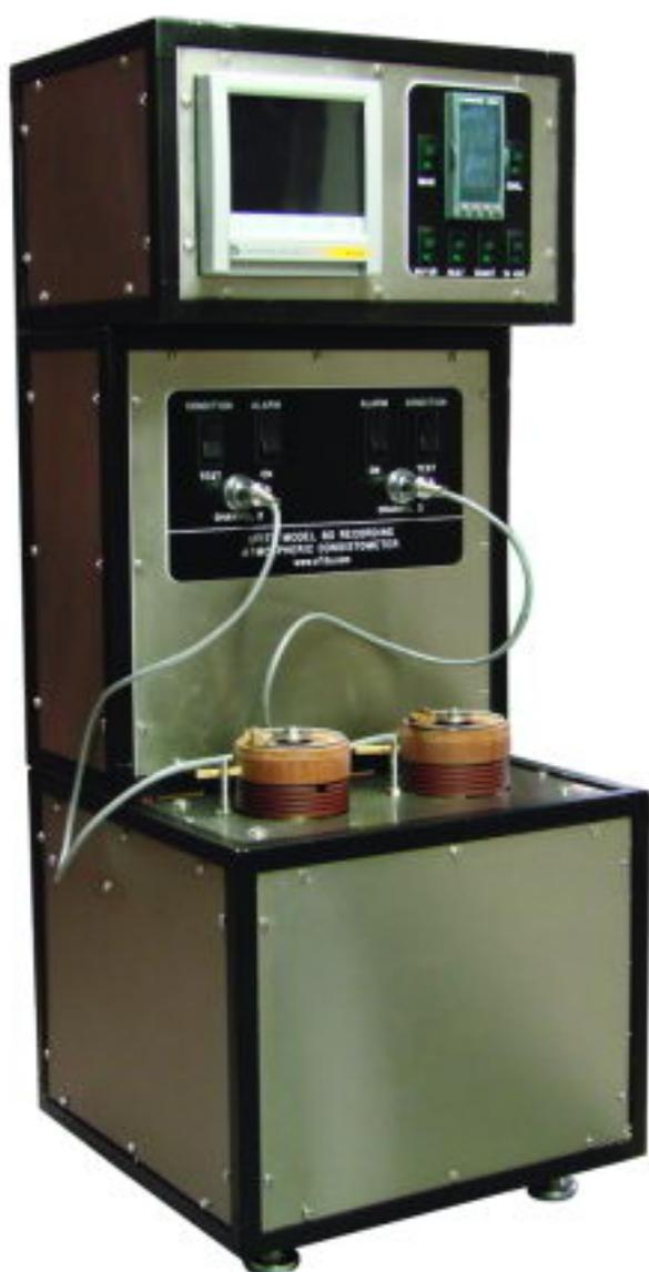
Атмосферный регистрирующий консистомер OFITE Модель 80 специально разработан для подготовки цементных растворов для проведения испытаний по различным параметрам в строгом соответствии со Спецификацией 10 Стандарта API (Американского Института Нефти). Определение реологических характеристик, содержание свободной воды в тампонажном растворе, определение водоотдачи раствора - все эти анализы могут быть выполнены с помощью атмосферного консистомера. Консистомер OFITE Модель 80 во многом схож с
